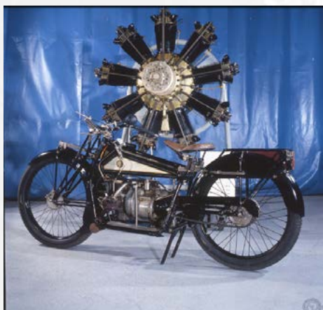
1922 ABC Gnome & Rhône 9Z de 60cv rotatif à 9 cylindres, c'est le dernier opérationnel de ce genre construit en 1920 en étoile Crédits photo : moto-collection.org Dominique Fradin
